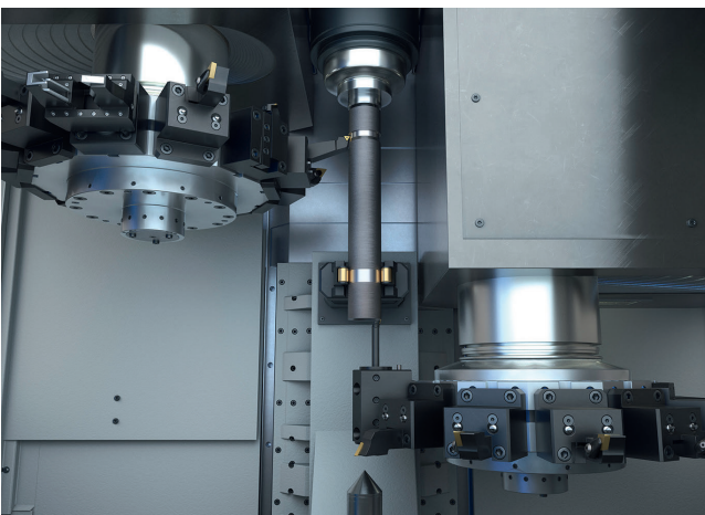
4 OP 10/20 – Vordrehen: Zwei 'VTC 200' von Emag stellen eine perfekte Lösung für die 4-achsige Wellenbearbeitung mit reduzierten Hauptzeiten dar © Emag
